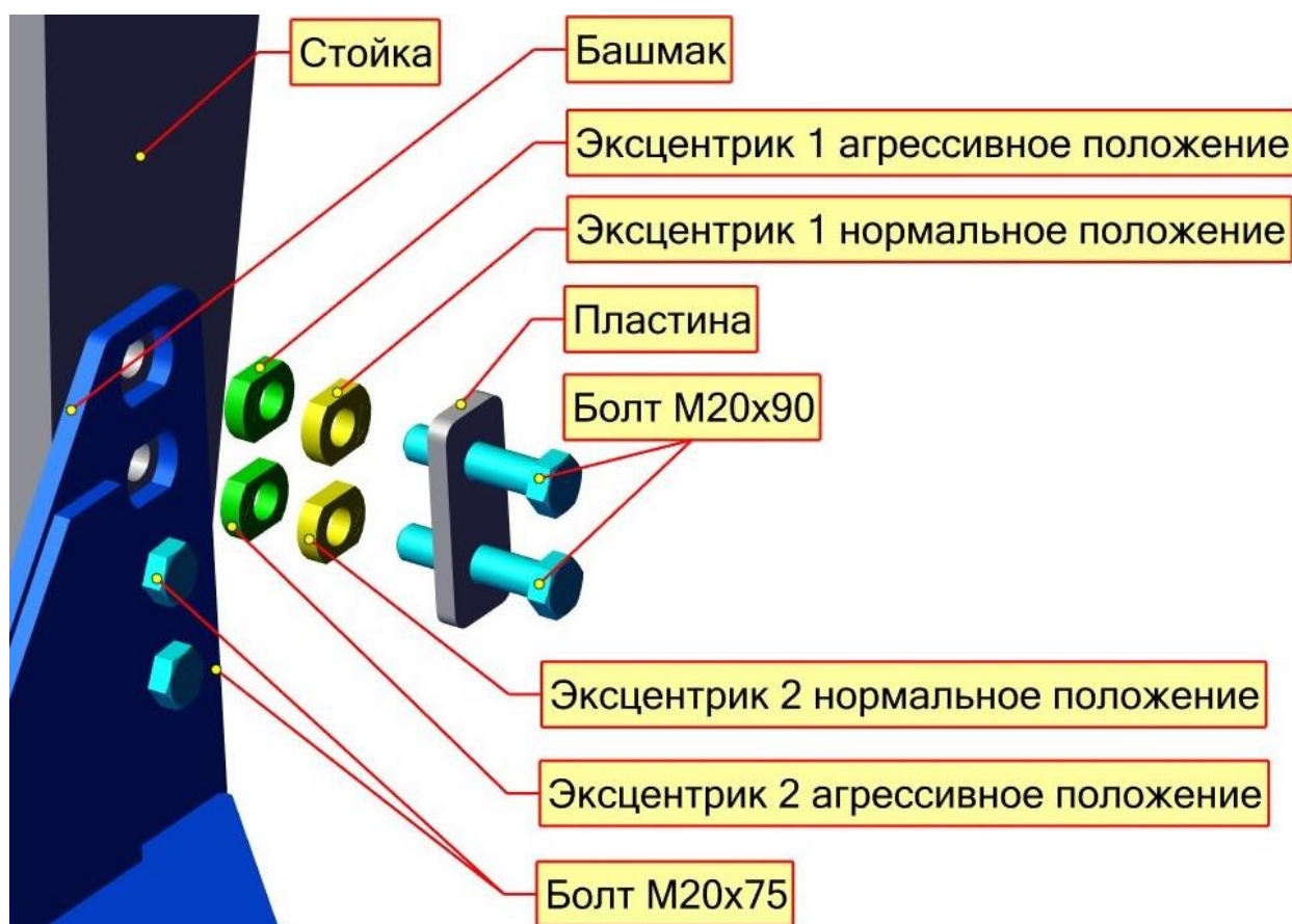
Рис. 1. Схема установки эксцентриков при нормальном и агрессивном способе обработки почвы.
